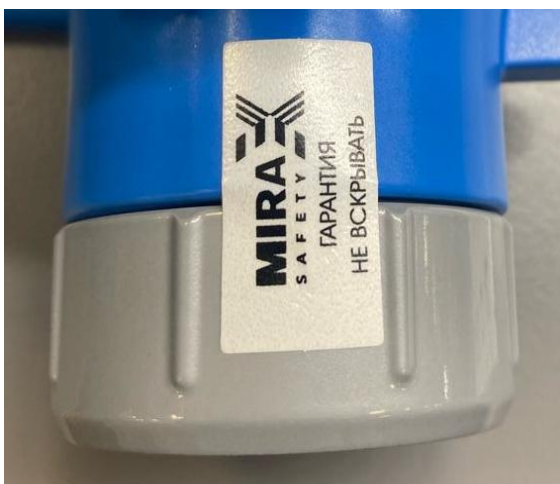
Рисунок 12 - Пломбировка узлов газоанализатора
