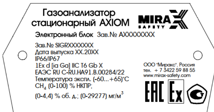
Рисунок 6 – Маркировочная табличка электронного блока газоанализатора AXIOM
