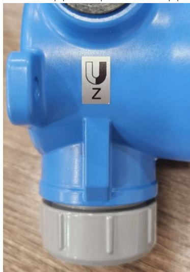
Рисунок 42 – зона калибровки «Z»
